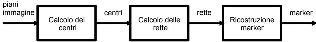
Figura 8: Schema a blocchi delle funzioni da implementare nel piano.
